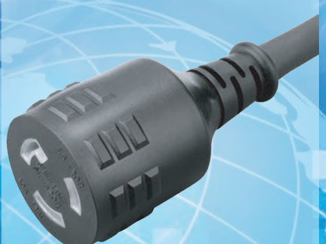
SL-520R (NEMA L5-20R) SJ, SJTO, SJO, SJTOW, SJTW 12 AWG/3C
