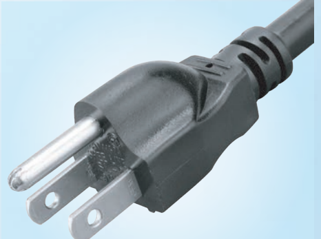
SL-2 (NEMA-5-15P) SVT 18AWG/3C SJT,SJTW,SJTO,SJTOW 18~12AWG/3C ST,STW,STO,STOW 18~16AWG/3C
